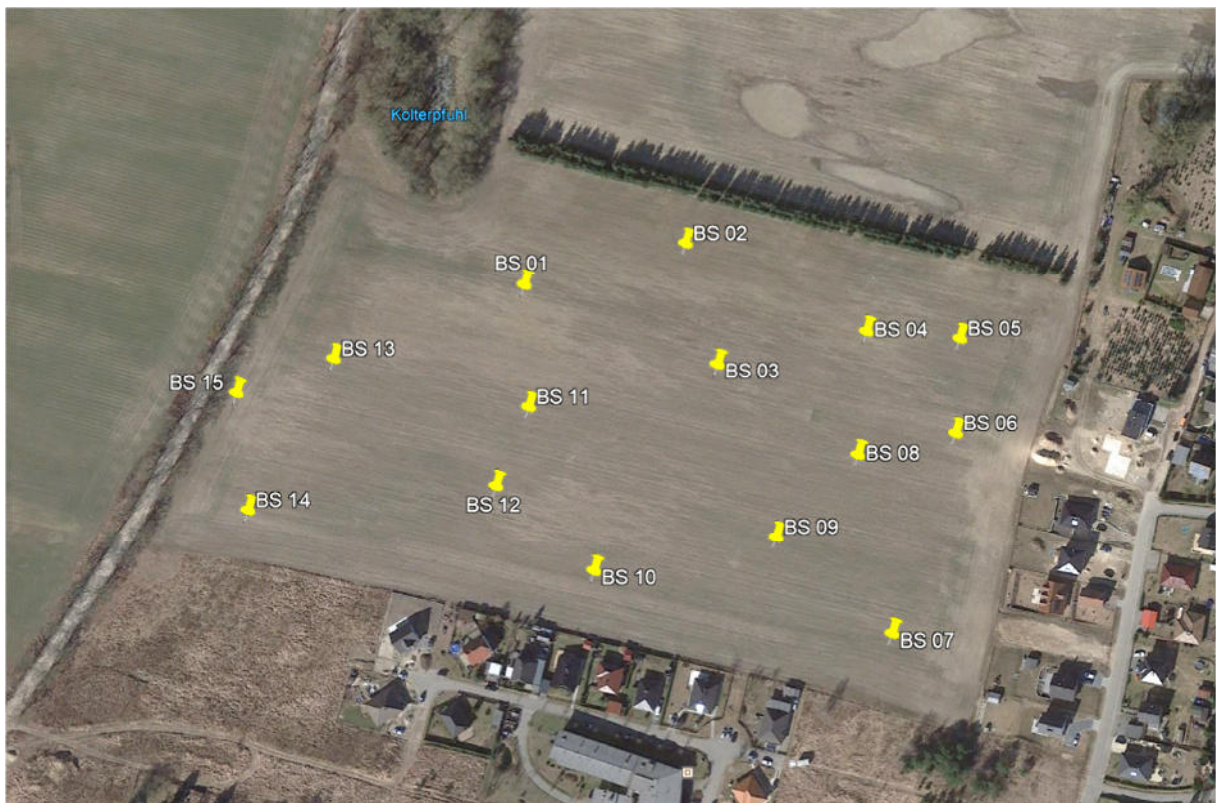
Abbildung 7: Sondierungsplan zur Baugrunderkundung (Dr. Marx, 2019)
